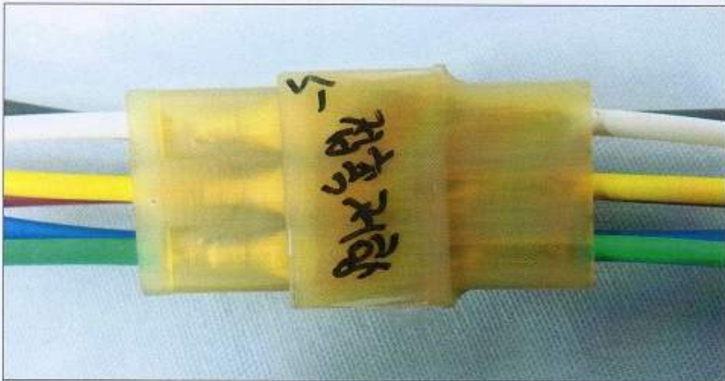
그림 6. 고온 시험 후 점속저항 시험품 사진(변색)
