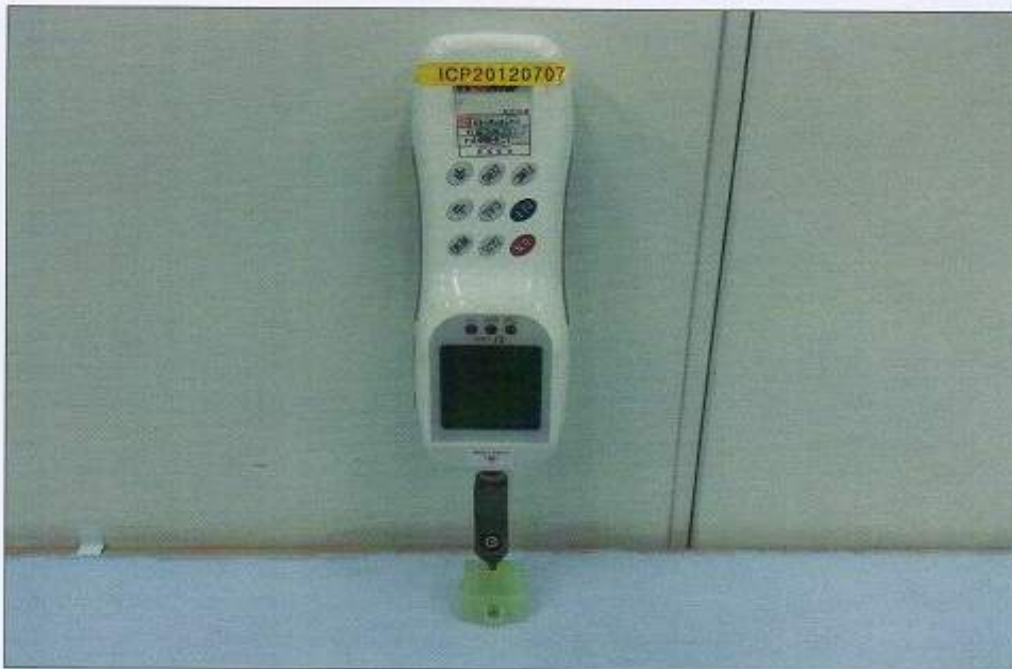
그림 18. Housing - Male Terminal 삽입력 시험장면
