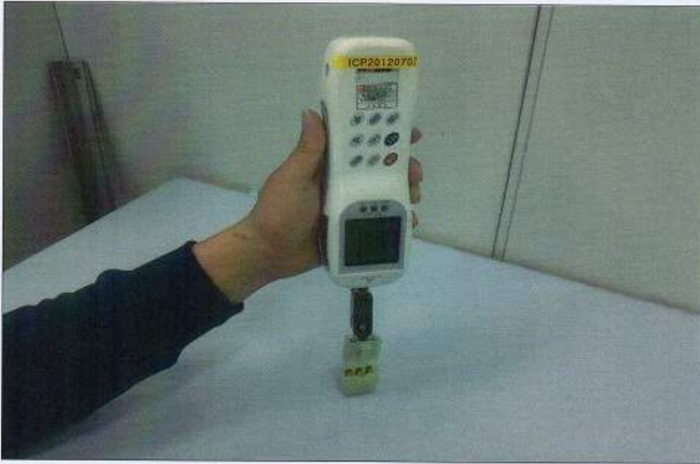
그림 17. Connector - Connector 삽입력 시험장면
