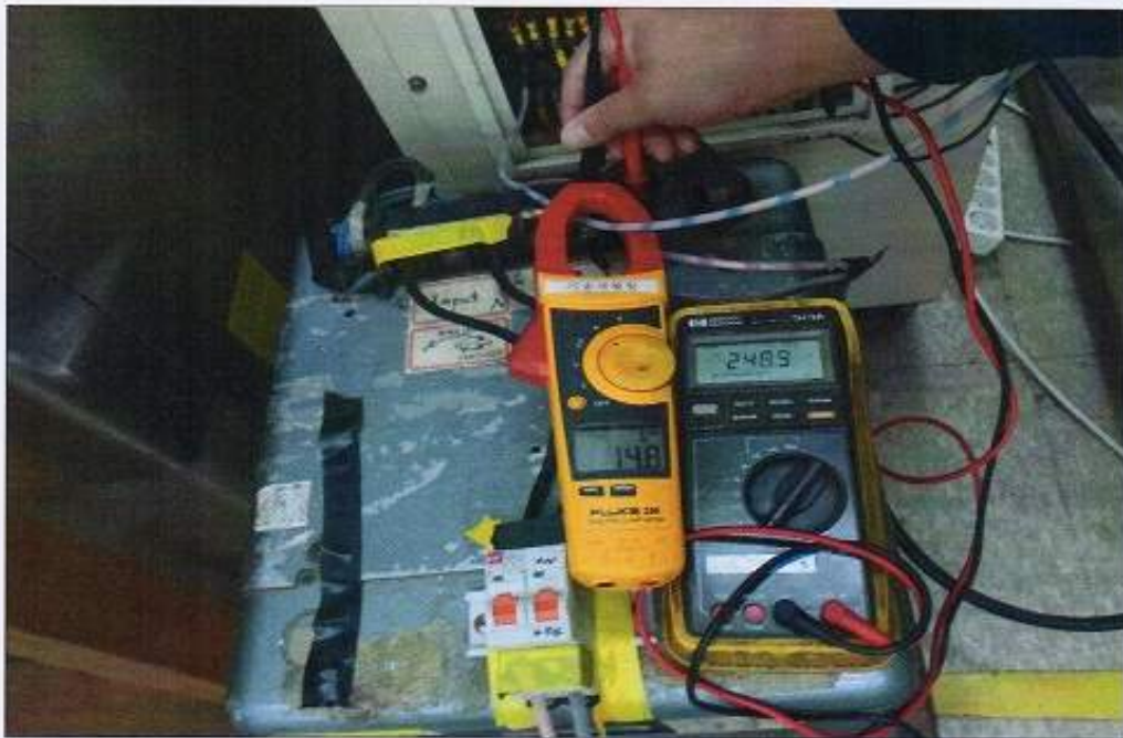
그림 14. 시험 전압 및 전류 확인
