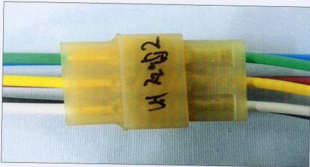
그림 8. 고온 시험 후 내전압 시험품(변색)
