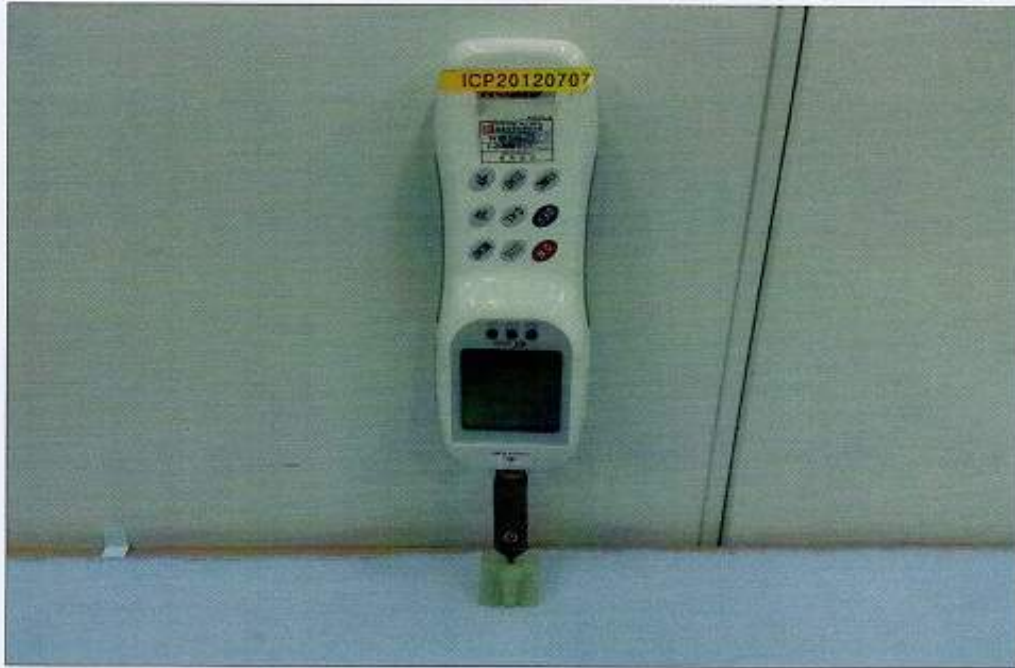
그림 19. Housing - Female Terminal 삽입력 시험장면
